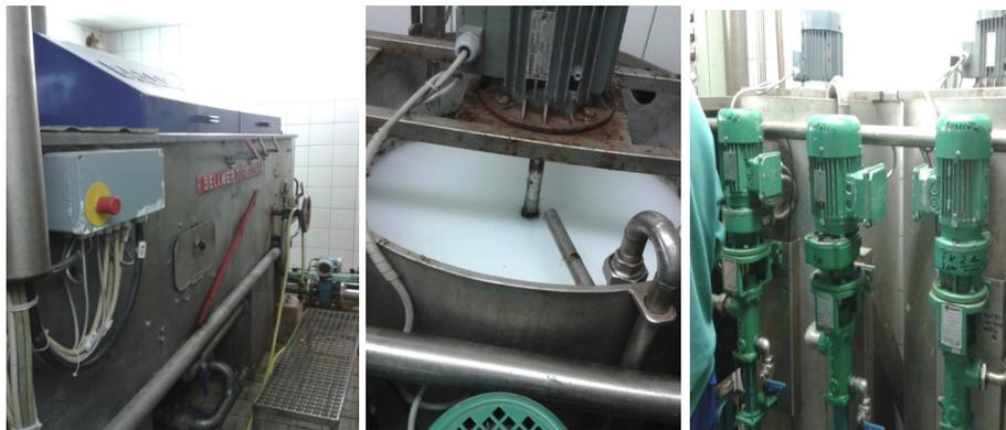
**Abbildung 3-4: Maschinelle Schlammverdickung mittels Siebband und Dosierung von Flockungshilfsmitteln**
